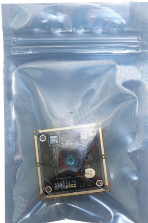
Sele a bandeja com um saco antiestático
